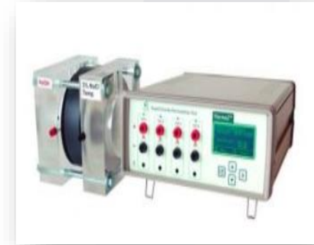
Beton Klorür Geçirimsizliğinin Hızlı Tayini
